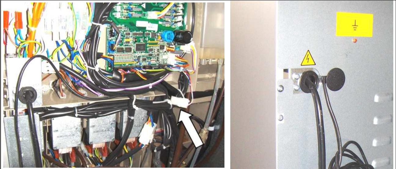
Smontare la schiena, connettere un capo del cavo seriale sul connettore indicato dalla freccia. Fissare il cablaggio con le fascette all'interno del sacchetto dotazione ricambi. Rimontare la schiena, e far passare il cavo seriale come mostrato in figura.
