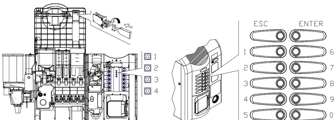
**Pulsante programmazione:** entrando in programmazione, il display visualizza **Comando 00**. Da questo menù principale, si può accedere direttamente ad alcuni dati oppure ad altri sottomenù. Digitare sulla **Pulsantiera a selezione diretta**, il corrispondente comando e premere **il tasto ENTER**, per confermare la scelta.
