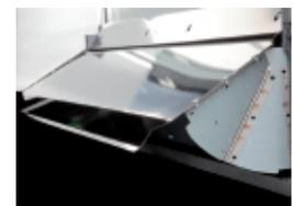
Trappe de prélèvement des produits renforcée
